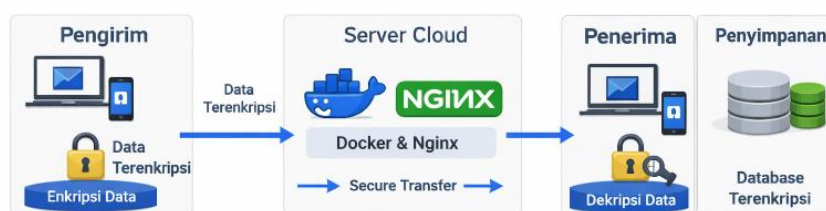
Gambar 2. Arsitektur Cloud Sederhana dengan Docker dan Nginx
